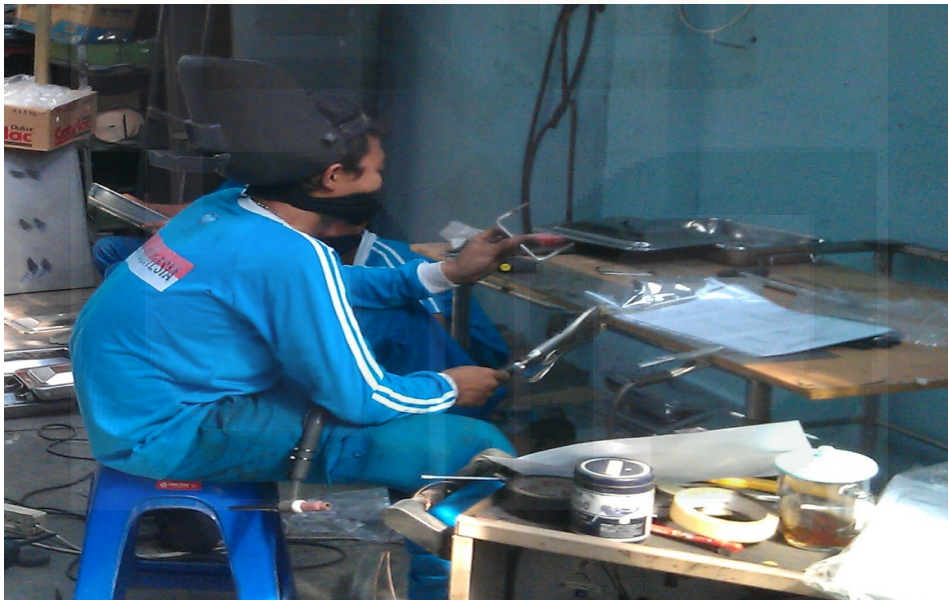
Pembuatan pegangan pada Sliding bed Ambulance
