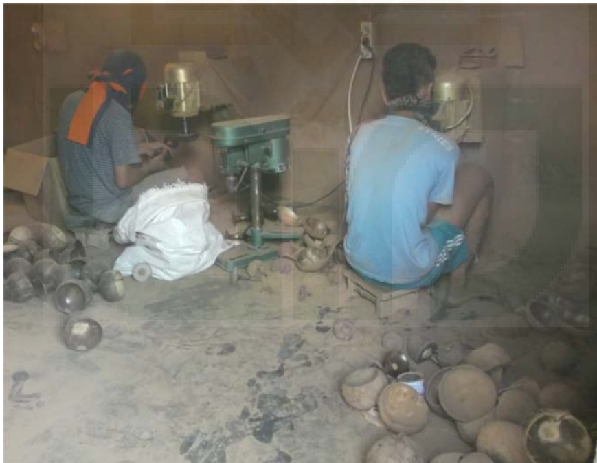
Proses pengamplasan atau penghalusan tempurung kelapa
