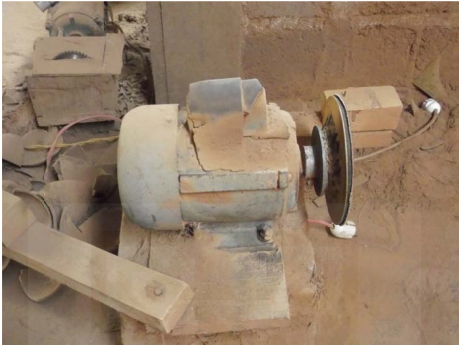
Mesin dinamo digunakan untuk mengamplas atau menghaluskan tempurung kelapa
