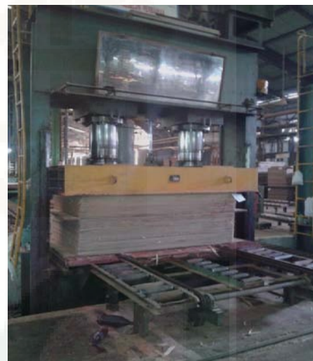
Gambar 5 Pengempaan Dingin pada Mesin Coldpress
