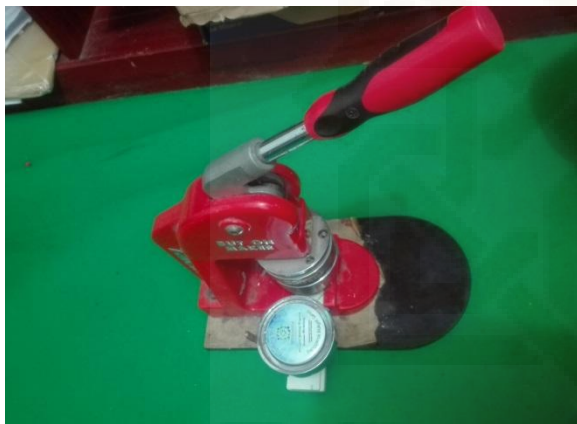
PROSES PEMBUATAN PIN DENGAN ALAT PRES PIN (DIGITAL PRINTING)
