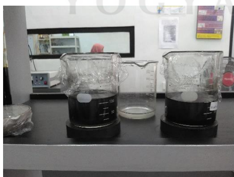
Proses pencucian sampel dengan diendapkan pada magnet permanen
