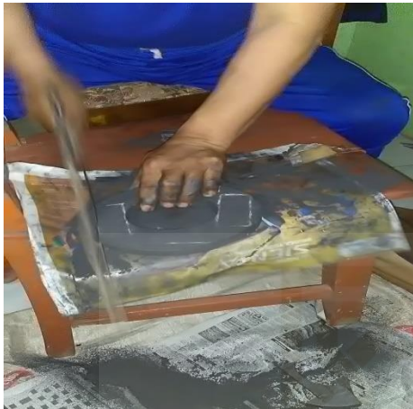
Gambar 7.5 Pemotongan elektroda karbon grafit
