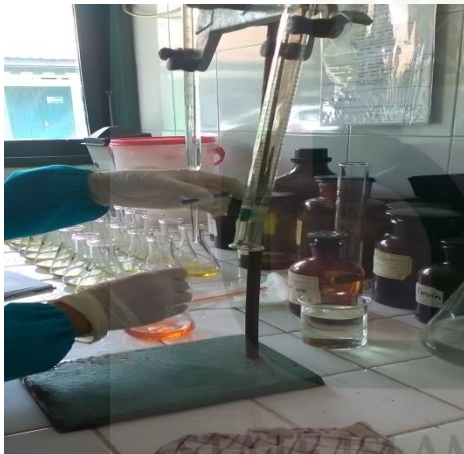
Gambar 7.22 Uji COD setelah dilakukan titrasi titrimetri
