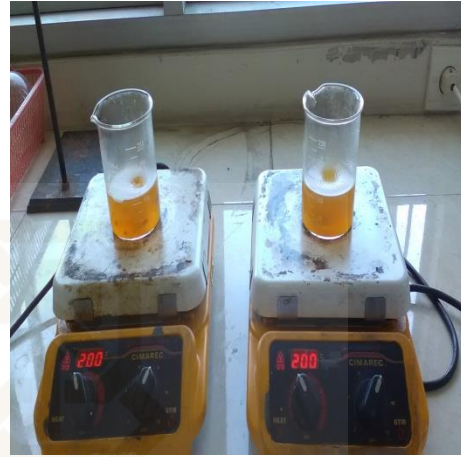
Gambar 7.2 Pembuatan jembatan garam di atas hot plate
