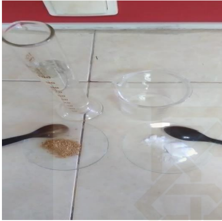
Gambar 7.1 Preparasi bahan pembuatan jembatan garam
