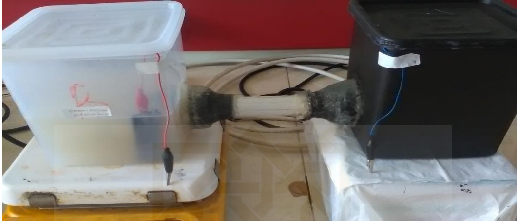
Gambar 7.16 Running reaktor MFC pada variasi limbah dengan penambahan glukosa dan elektroda 44,5 \text{ cm}^2
