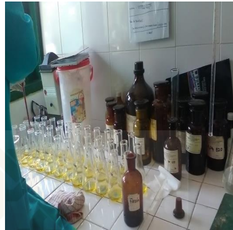
Gambar 7.21 Uji COD sebelum dilakukan titrasi titrimetri
