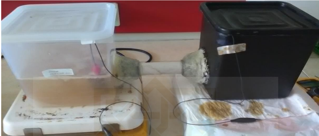
Gambar 7.18 Running reaktor MFC pada variasi limbah tanpa penambahan glukosa dan elektroda 44,5 \text{ cm}^2
