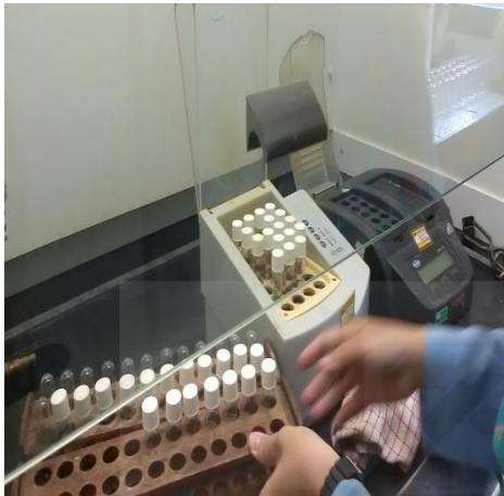
Gambar 7.20 Pemanasan botol COD dalam alat refluks
