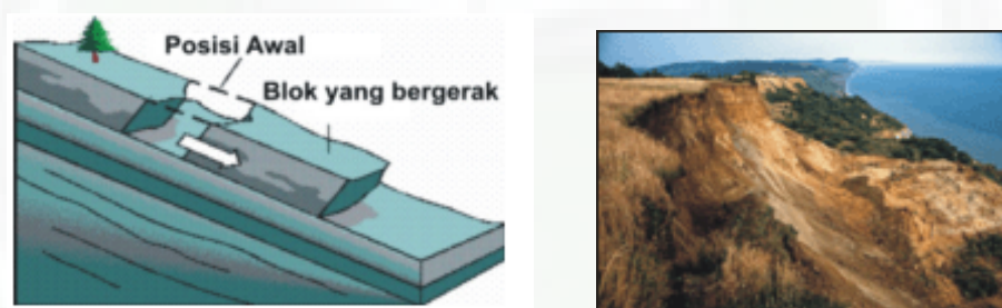
Gambar (7). Pergeseran Tanah Akibat gorong-gorong atau lubang-lubang interior
