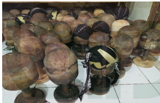
Gambar 5: Klebut sebagai dudukan membuat blangkon mengukur untuk ukuran kepala
