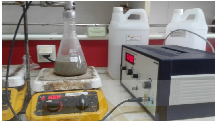
Proses sintesis organoclay dengan metode sonikasi
