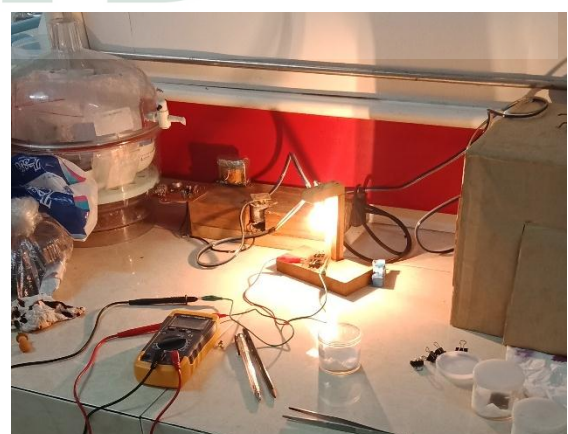
Perakitan Sistem DSSC ZnO:Zr 1%
