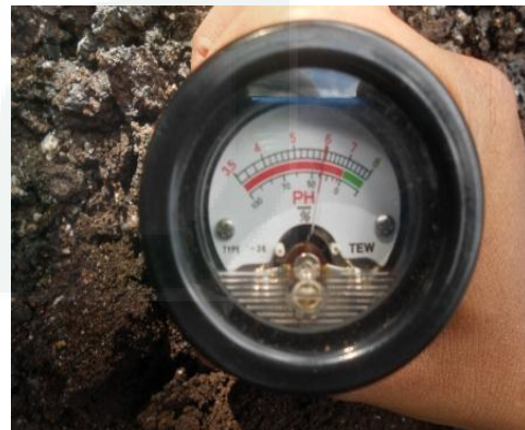
Pengukuran kelembaban tanah pada tanah tercemar di pengecoran logam Klaten.
