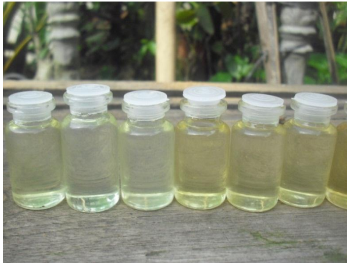
Gambar 3. 3 Sampel latih bensin murni dari kiri ke kanan dengan 3 sampel latih bensin campuran minyak goreng bekas 5%
