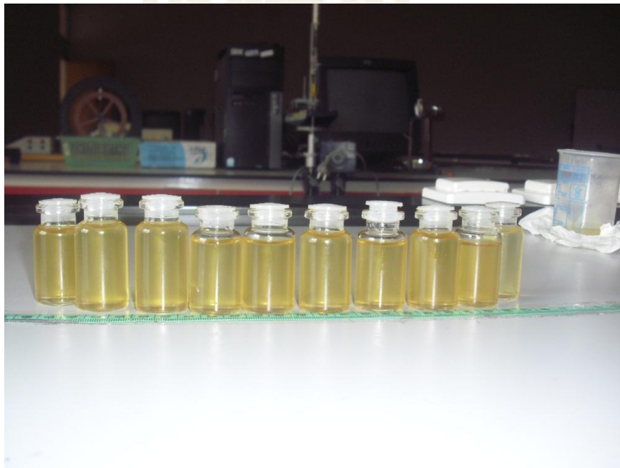
Gambar 4. Sampel uji bensin campuran minyak goreng bekas 5% sistem deteksi
