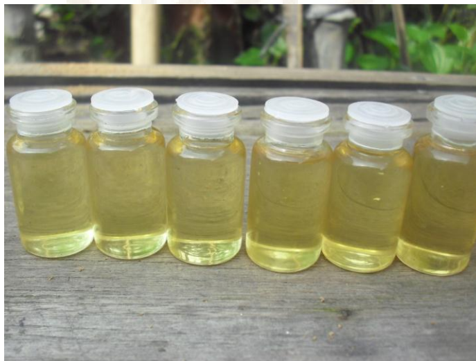
Gambar 6. 3 Sampel latih bensin campuran minyak goreng bekas 10% dan 3 sampel latih bensin campuran minyak goreng bekas 15% dari kiri ke kanan
