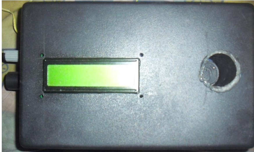
Gambar. Sistem deteksi bensin campuran menggunakan LED dan fotodioda
