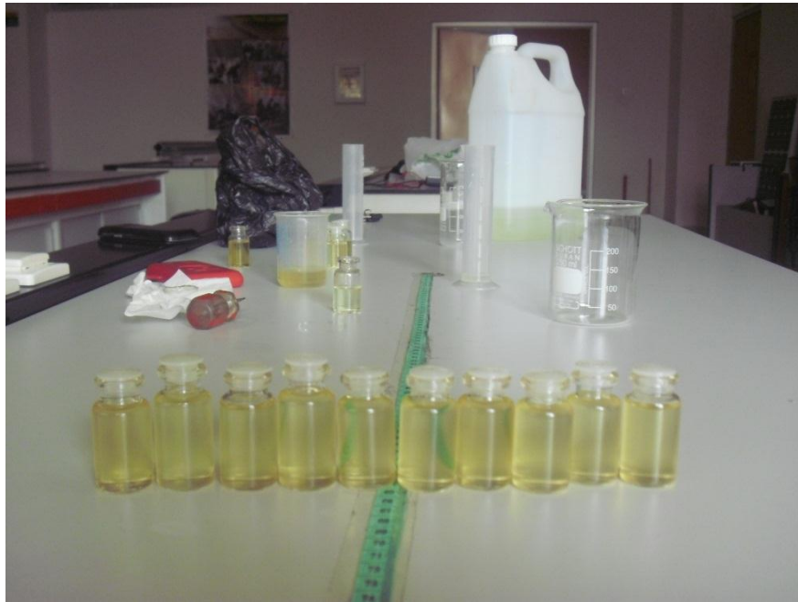
Gambar 3. Sampel uji bensin campuran minyak goreng bekas 5% sistem deteksi
