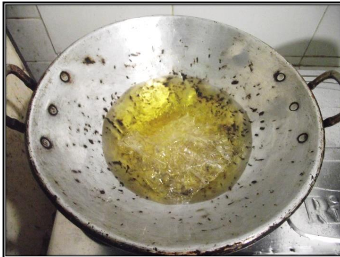
Gambar 9. Pembuatan sampel dengan mencampurkan plastik ke dalam minyak goreng
