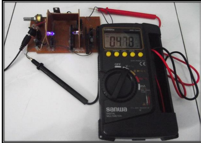
Gambar 8. Pengambilan data untuk karakterisasi sensor photodiode
