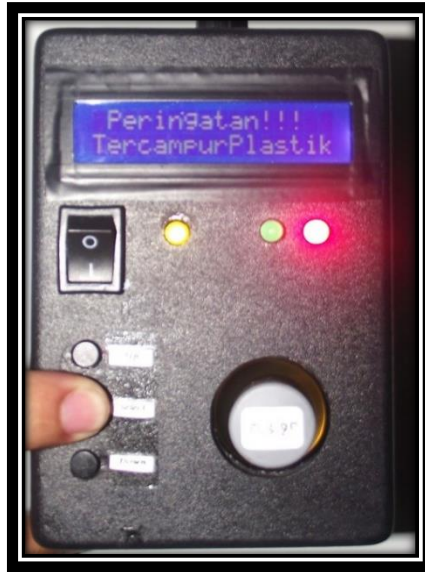
Gambar 12. Implementasi sistem deteksi (untuk memulai mendeteksi dilakukan dengan menekan tombol select )
