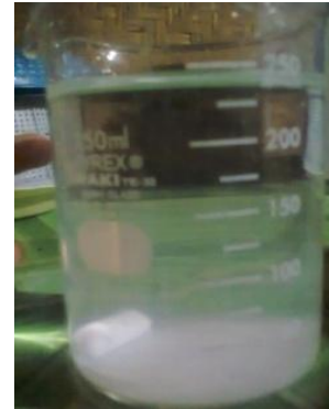
Gb.3 Proses pencucian dengan aquades, endapan putih merupakan silika
