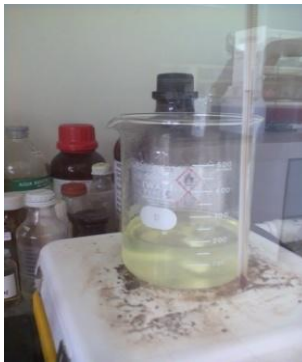
Gb.1 Proses larutan \text{Na}_2\text{SiO}_3 dan \text{HCl} 2M dengan dipanaskan dan distirir
