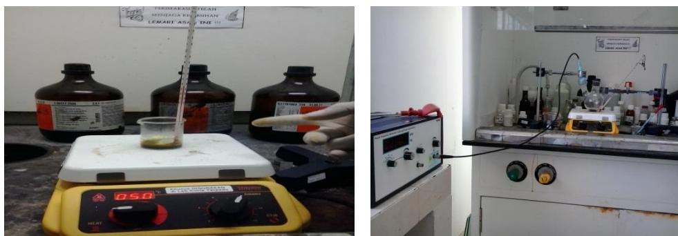
Gambar 5.1. Proses Sintesis dengan penambahan HCl dan NaOH sambil disonifikasi
