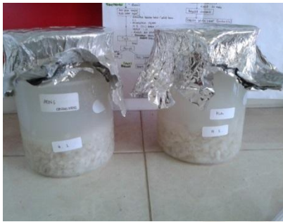
Lampiran 2. Proses Perendaman dengan \text{CH}_3\text{COOH} 1,5% (v/v).
