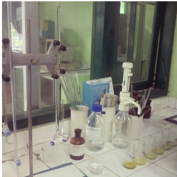
(d) Seperangkat alat untuk uji parameter COD
