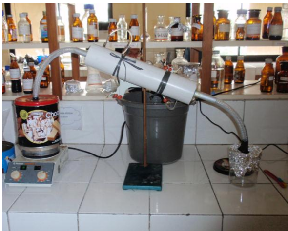
Gambar 3. Perangkat kondensor sederhana sebagai alternatif perangkat distilasi.
