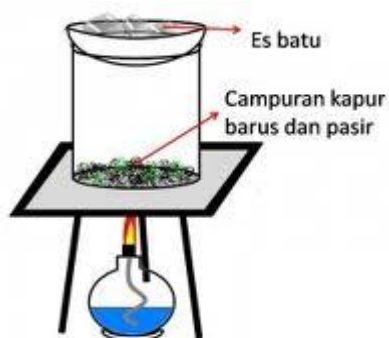
Gambar 4.1 Perangkat alat sublimasi
