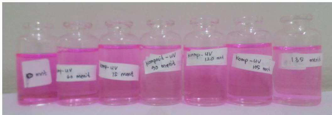
13.11 Larutan *Rhodamine B* Hasil Fotodegradasi Variasi Waktu Menggunakan Komposit Zeolit/TiO<sub>2</sub> tanpa Penyinaran UV
