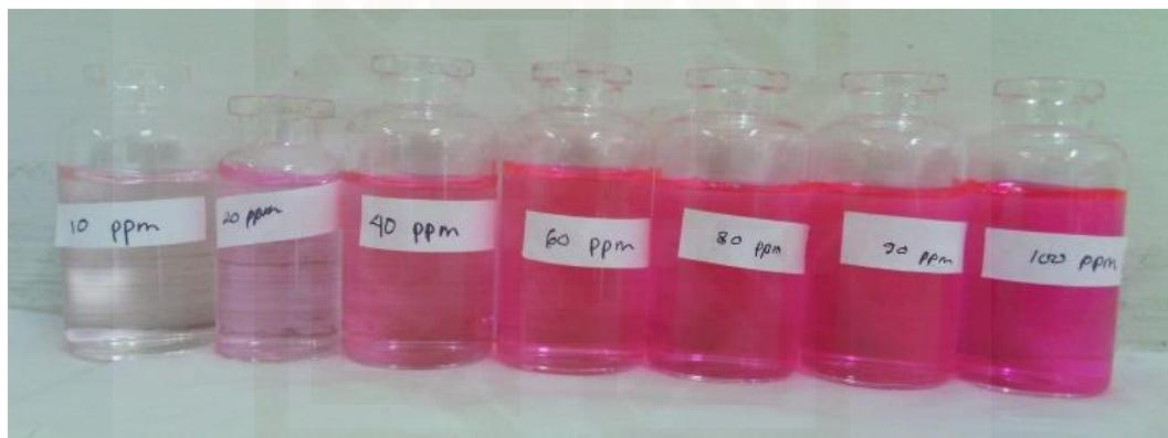
13.12 Larutan *Rhodamine B* Hasil Fotodegradasi Variasi Konsentrasi Menggunakan Komposit Zeolit/TiO<sub>2</sub> dengan Penyinaran UV
