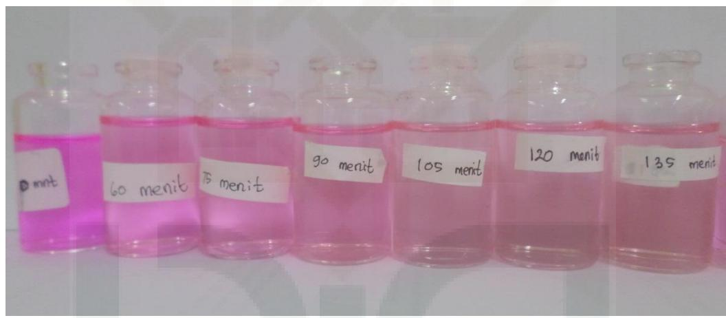
13.9 Larutan *Rhodamine B* Hasil Fotodegradasi Variasi Waktu Menggunakan Komposit Zeolit-TiO<sub>2</sub> dengan Penyinaran UV
