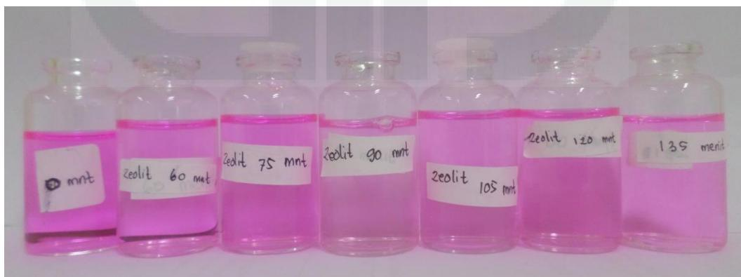
13.10 Larutan *Rhodamine B* Hasil Fotodegradasi Variasi Waktu Menggunakan Zeolit dengan Penyinaran UV
