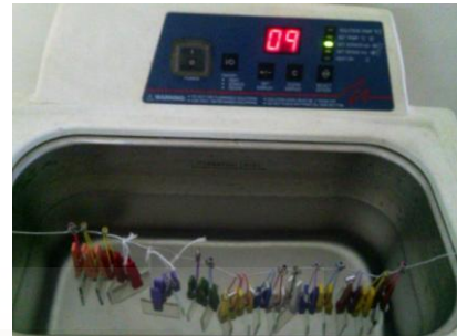
Gambar 2. Pembersihan kaca dengan Ultrasonic cleaner
