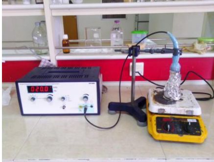
Gambar 7. Pembuatan pasta \text{TiO}_2 dengan Proses Sonikasi
