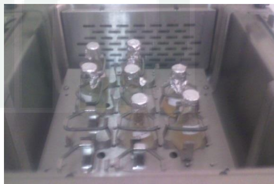
Gambar 6. Adsorpsi logam Cu(II) pada sistem batch menggunakan shaker waterbath .
