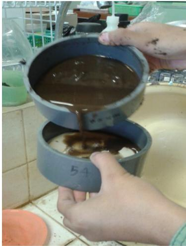
Gambar 7. Penyaringan sampel tanah (saringan 75 $\mu$ m ke 54 $\mu$ m)
