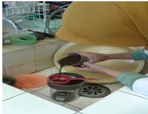
Gambar 6. Penyaringan sampel tanah (saringan 75  $\mu\text{m}$ ).
