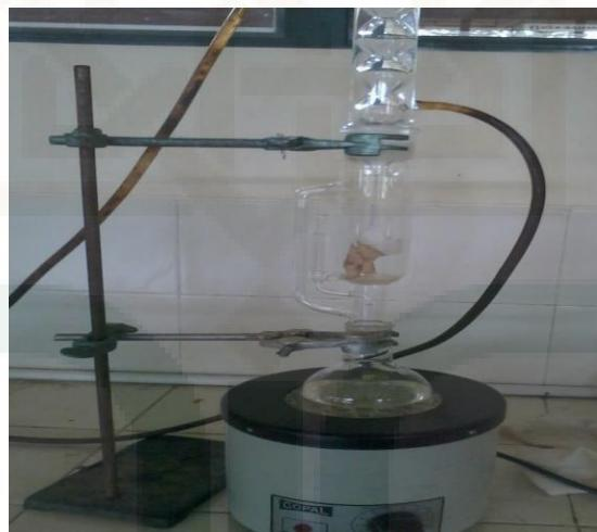
(d) alat *soxlet* dalam uji kadar lemak
