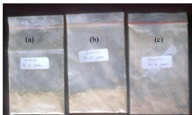
Gambar 9.3 Zeolit sintesis dari abu dasar batubara (a) kalsinasi 2 jam, (b) kalsinasi 4 jam, dan (c) kalsinasi 6 jam.
