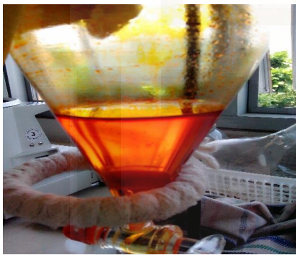
Proses ekstraksi dengan kloroform
