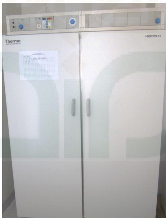
Gambar 28. Inkubator ( Thermo Electron Corporation Heraeus ) untuk Inkubasi Bakteri
