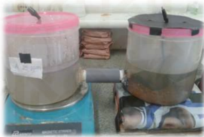
Gambar 5.29 Hasil Running setelah 60 jam reaktor SBMFC pada variasi katolit \text{KMnO}_4 25 ppm (Blanko atau Kontrol)
