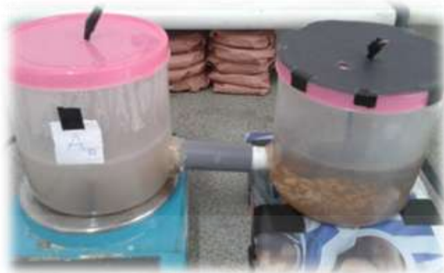
Gambar 5.26 Hasil Running setelah 60 jam reaktor SBMFC pada variasi katolit \text{KMnO}_4 10 ppm (Blanko atau Kontrol)
