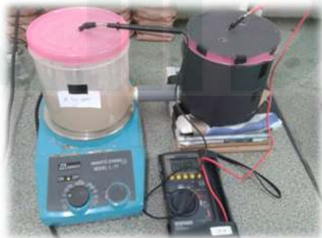
Gambar 5.33 Running reaktor SBMFC pada variasi katolit \text{KMnO}_4 50 ppm (Blanko atau Kontrol)
