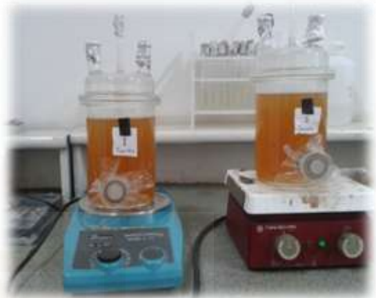
Gambar 5.13 Aklimatisasi mikroba pada 100% media dalam 0% limbah
