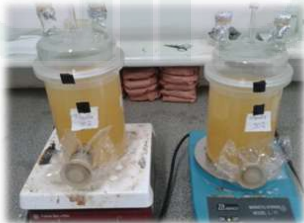
Gambar 5.15 Aklimatisasi mikroba pada 30% media dalam 70% limbah
