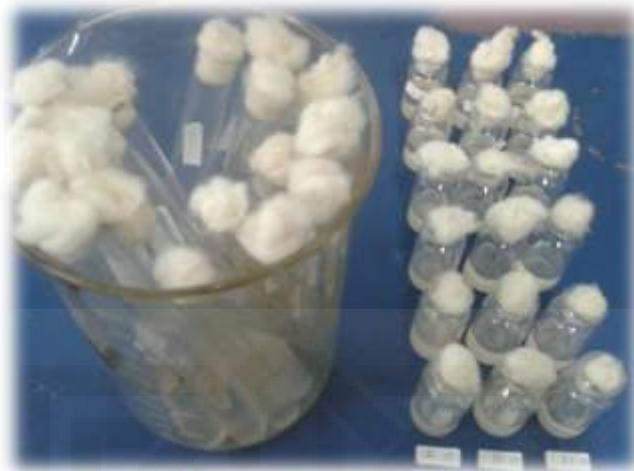
Gambar 5.31 Sampling COD reaktor SBMFC pada variasi katolit \text{KMnO}_4 25 ppm dan \text{KMnO}_4 10 ppm (botol kecil)
