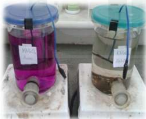
Gambar 5.36 Perbandingan \text{KMnO}_4 awal dengan \text{KMnO}_4 akhir (setelah running SBMFC)
