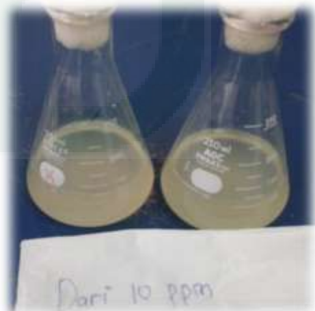
Gambar 5.27 Inokulum mikroba dari Running reaktor SBMFC pada variasi katolit \text{KMnO}_4 10 ppm
