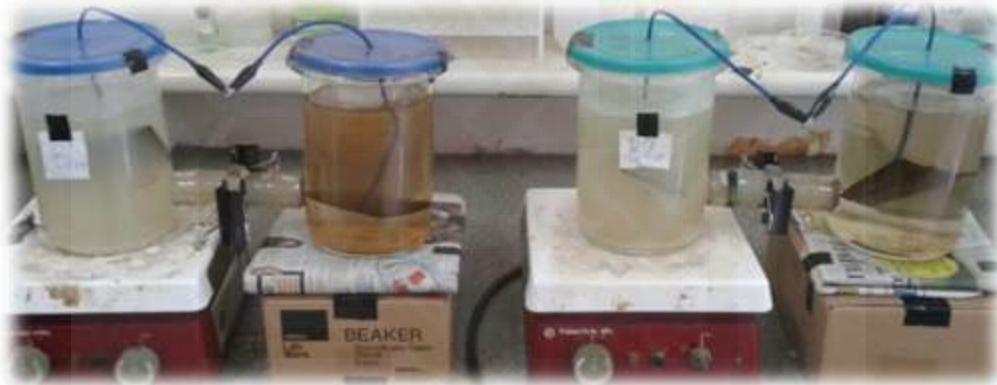
Gambar 5.27 Hasil Running setelah 60 jam reaktor SBMFC pada variasi katolit \text{KMnO}_4 10 ppm B1 dan B2 (Duplo)
