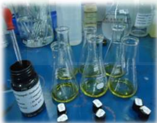
Gambar 5.42 Uji COD sebelum dilakukan titrasi titrimetri
