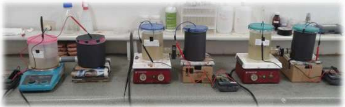
Gambar 5.28 Running reaktor SBMFC pada variasi katolit \text{KMnO}_4 25 ppm
