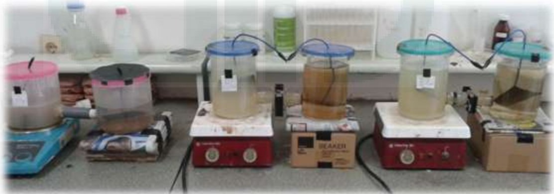
Gambar 5.25 Hasil Running setelah 60 jam reaktor SBMFC pada variasi katolit \text{KMnO}_4 10 ppm
