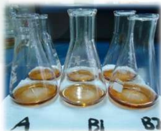
Gambar 5.43 Uji COD setelah dilakukan titrasi titrimetri
