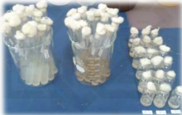
Gambar 5.35 Sampling COD reaktor SBMFC pada variasi katolit \text{KMnO}_4 10, 25 dan 50 ppm (botol kecil)
