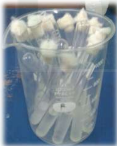
Gambar 5.26 Sampling COD reaktor SBMFC pada variasi katolit \text{KMnO}_4 10 ppm
