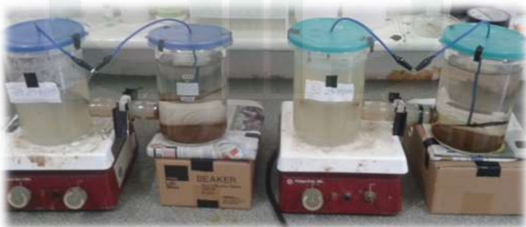
Gambar 5.30 Hasil Running setelah 60 jam reaktor SBMFC pada variasi katolit \text{KMnO}_4 25 ppm B1 dan B2 (Duplo)
