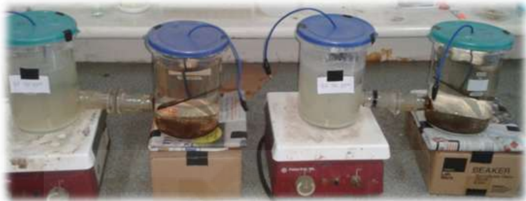
Gambar 5.34 Hasil Running setelah 60 jam reaktor SBMFC pada variasi katolit \text{KMnO}_4 50 ppm B1 dan B2 (Duplo)
