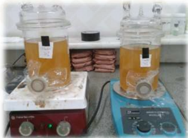
Gambar 5.14 Aklimatisasi mikroba pada 70% media dalam 30% limbah
