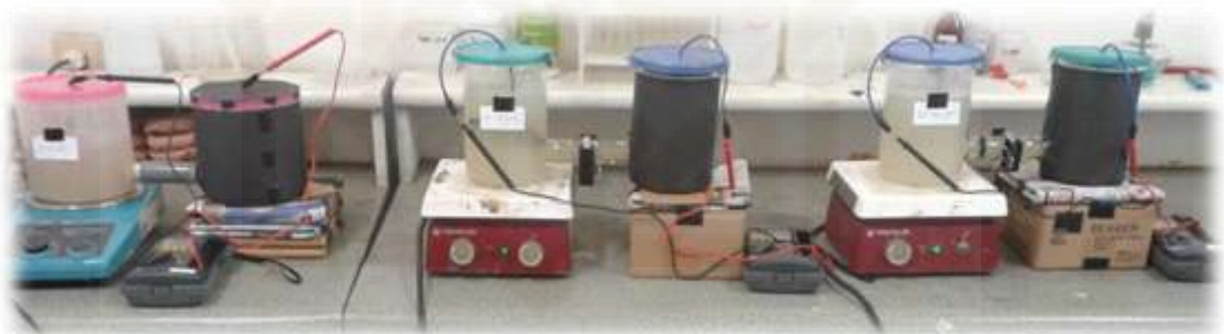
Gambar 5.32 Running reaktor SBMFC pada variasi katolit \text{KMnO}_4 50 ppm
