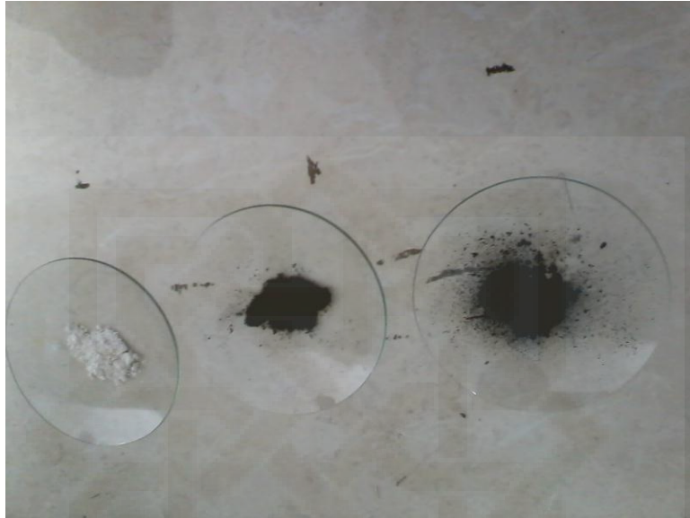
Gambar 1. Gambar kaolin, kaolinit-besi oksida, dan besi oksida
