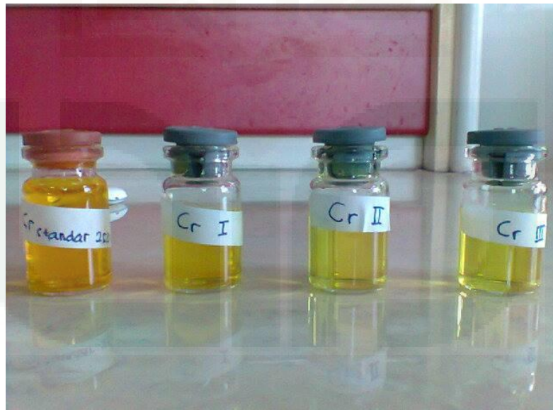
Gambar 2. Hasil proses remediasi \text{Cr}^{6+} menggunakan kaolin, kaolinit-besi oksida, dan besi oksida
