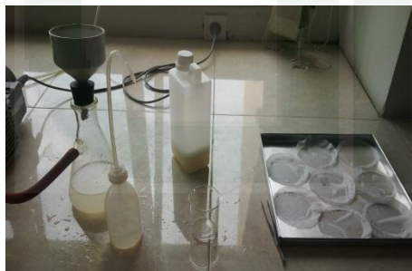
Gambar 7.3. Penyaringan uji TSS
