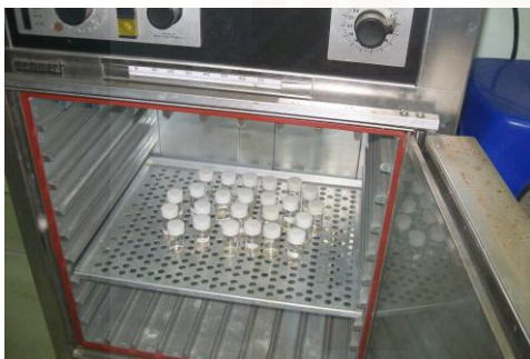
Gambar 17. Proses maserasi dengan oven
