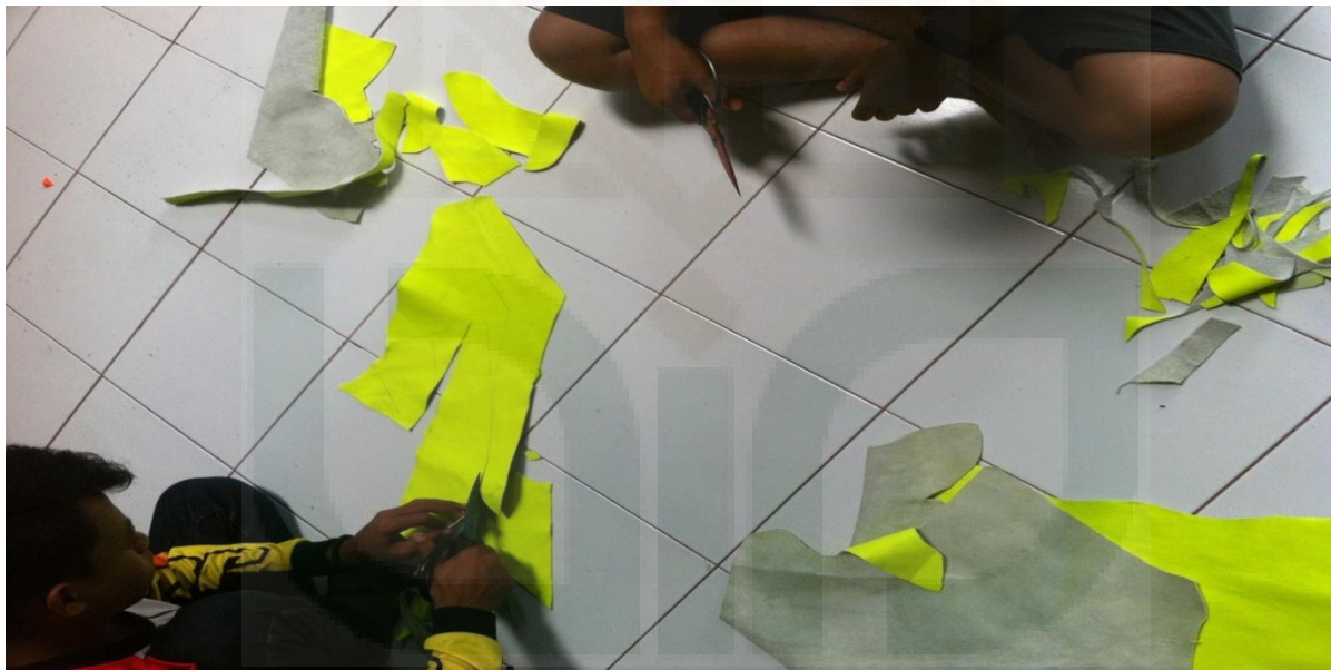
Gambar 12 : pemotongan kulit sesuai dengan pola (sketsa) dari desain dan ukuran.
