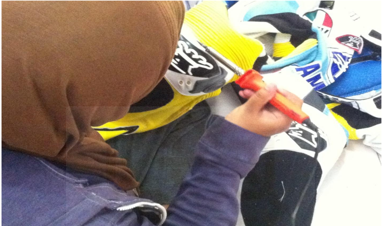
Gambar 25 : pemasangan kevlar bagian lutut dan bagian bahu
