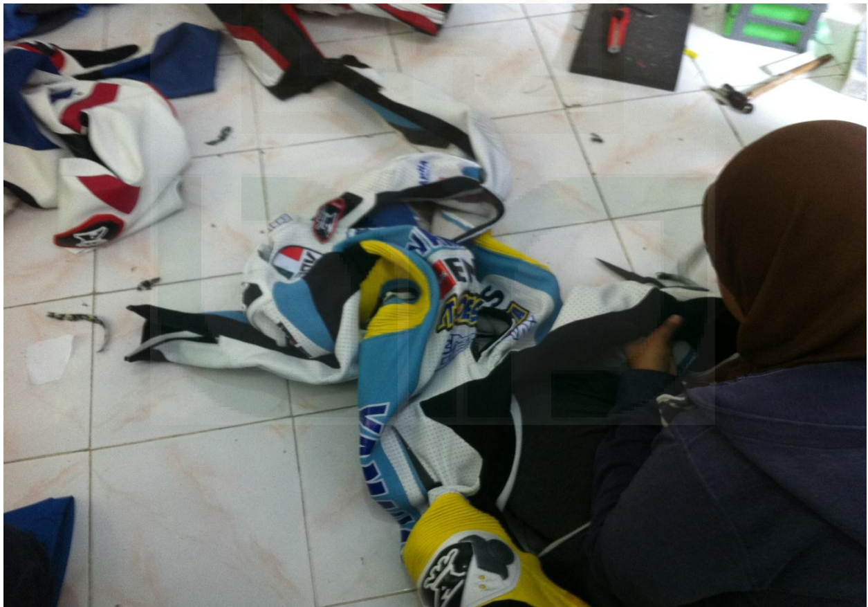
Gambar 28 : pemasangan purring dan proses inspeksi
