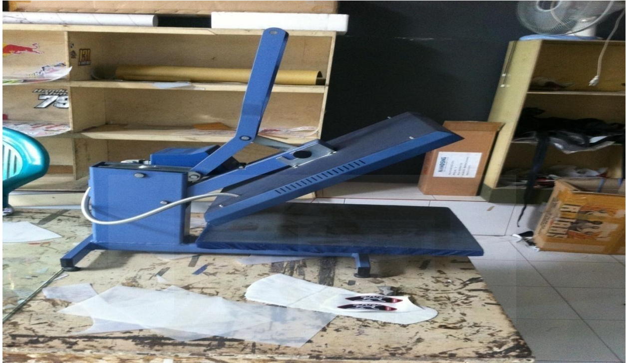
Gambar 19 : mesin press untuk memanaskan hasil dari sablonan
