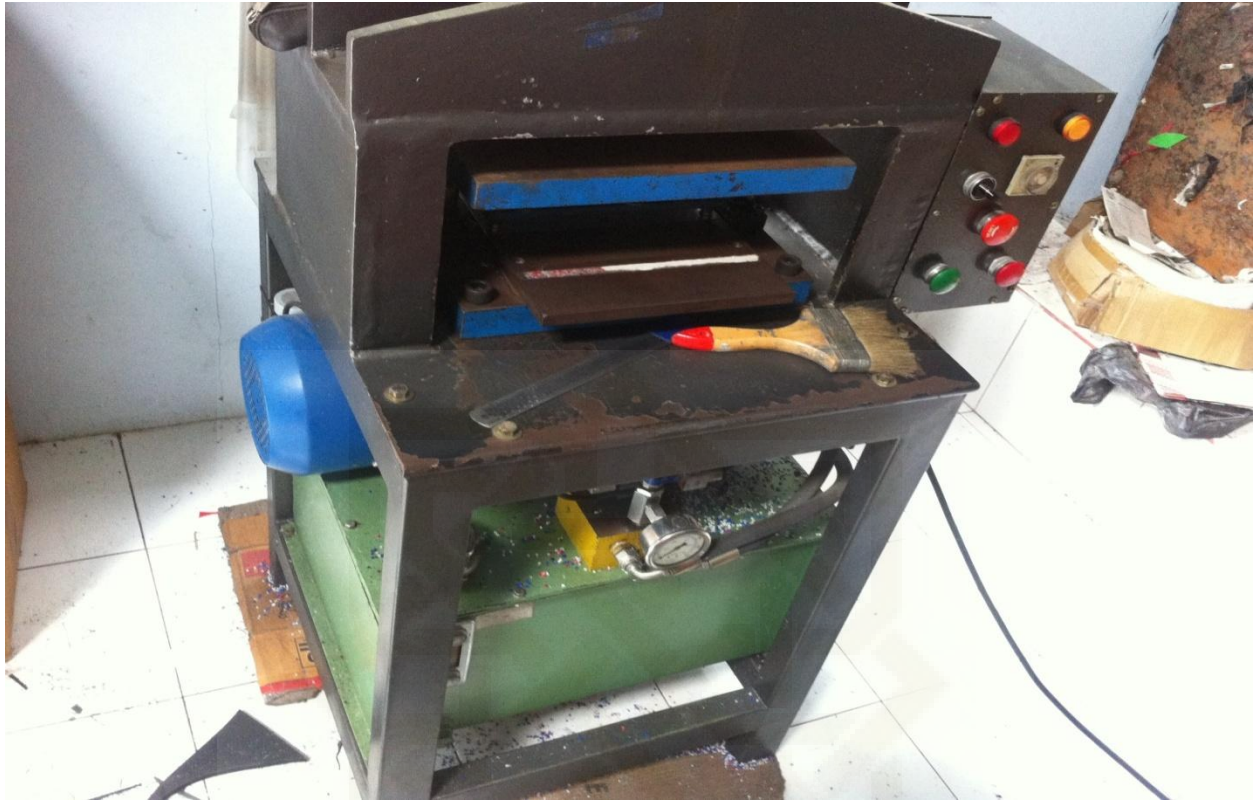
Gambar 17 : mesin pembuatan lubang untuk kulit.
