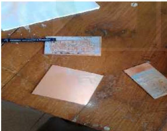
Gambar cetakan skema rangkaian pada PCB polos
