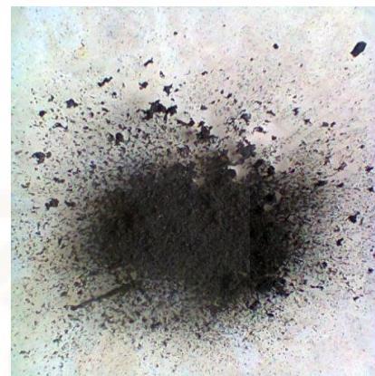
Gambar 3 Hasil pengeringan komposit Besi-CMC dengan vakum *dessicator*.
