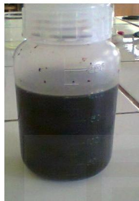
Gambar 5 Pengujian agglomerasi komposit Besi-CMC dari 1 hari-2 minggu
