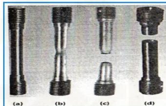
Gambar 1.6 Sampel logam yang diberi beban
