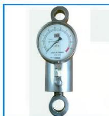
Gambar 1.10 Dinamometer
