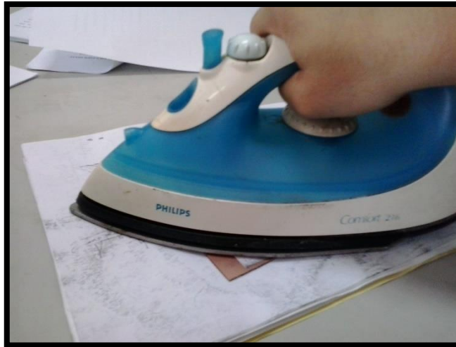
Gambar1. Penempelan layuot pada PCB
