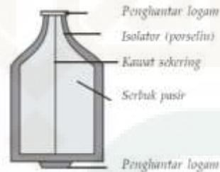
**Gambar 2. Skema Sekering**
