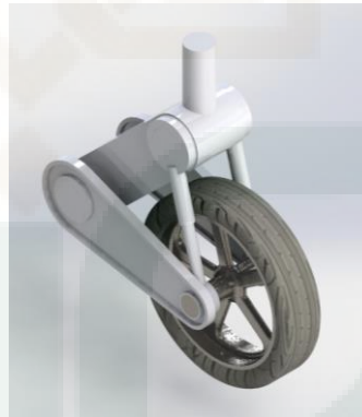
Gambar 4.4. Roda Depan Bersuspensi
