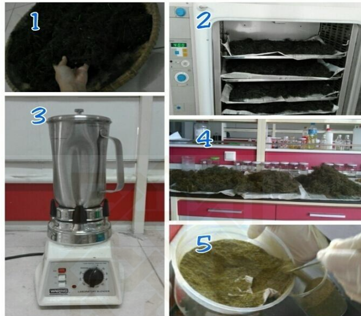
Gambar 10. Pengolahan daun adas dari mulai dikering-anginkan, di oven, diblender hingga menjadi serbuk daun adas
