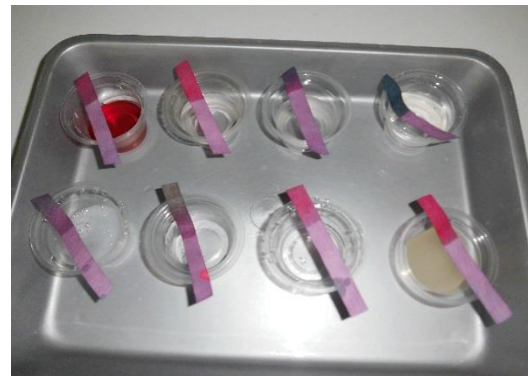
Indikator kertas belimbing wuluh diujikan pada berbagai larutan (sumber : dokumen pribadi)
