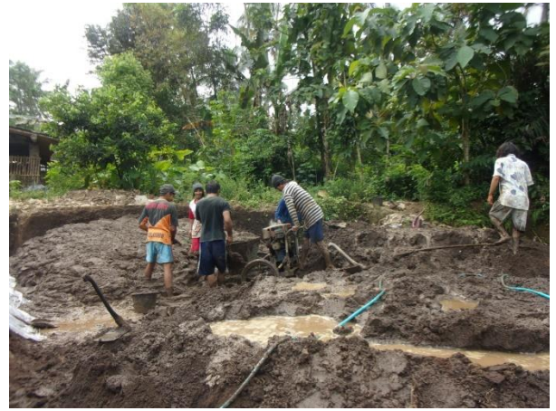
Keterangan : Proses pengambilan bahan baku dan penggilingan bahan baku untuk dicetak menjadi genteng
