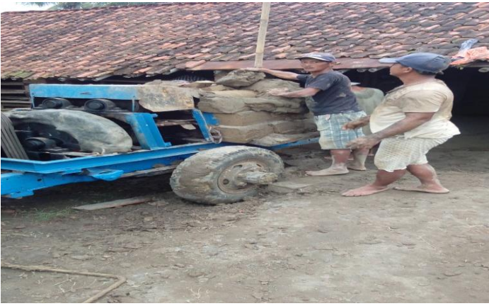
Keterangan : Proses pengambilan bahan baku dan penggilingan bahan baku untuk dicetak menjadi genteng
