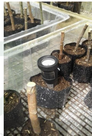
Gambar 19. Pengukuran Kelembaban Tanah
