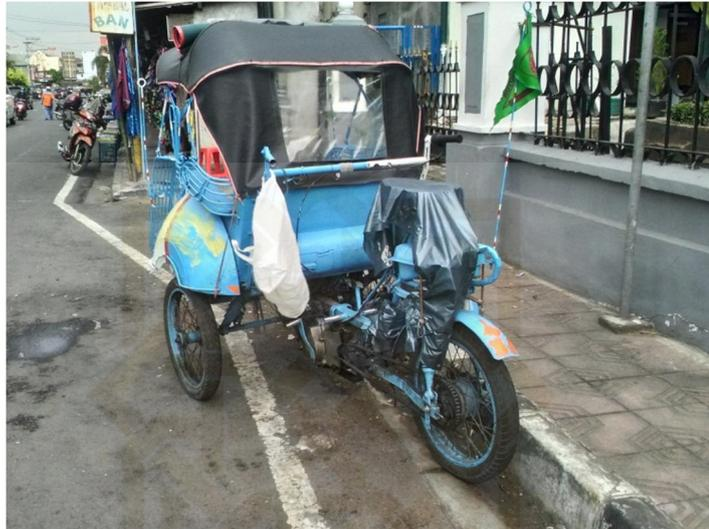
Gambar 1. Gambaran becak dengan tambahan mesin sepeda motor
