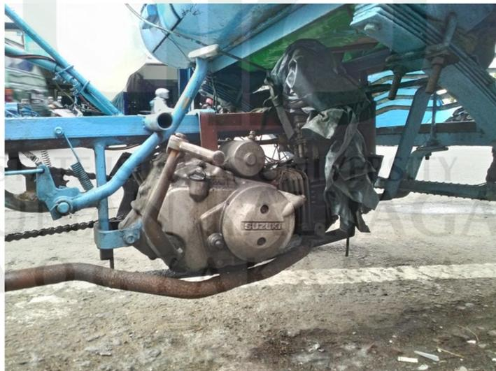
Gambar 2. Becak motor yang hanya memasukkan mesin saja pada becaknya
