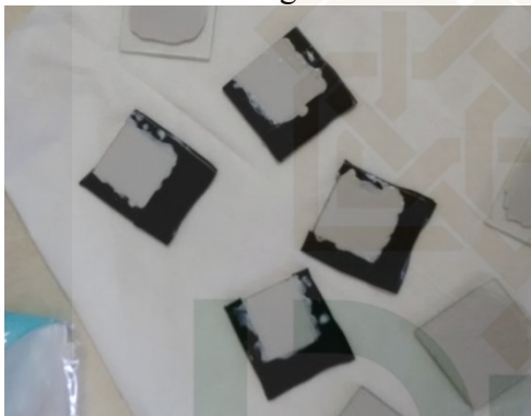
Deposisi ZnO:Zr 1% pada kaca ITO
