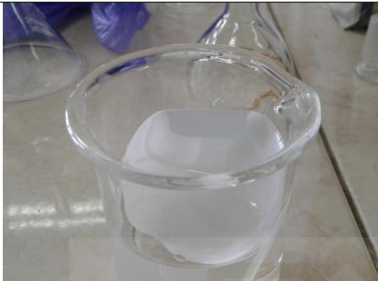
Perendaman membran nylon dalam larutan monomer
