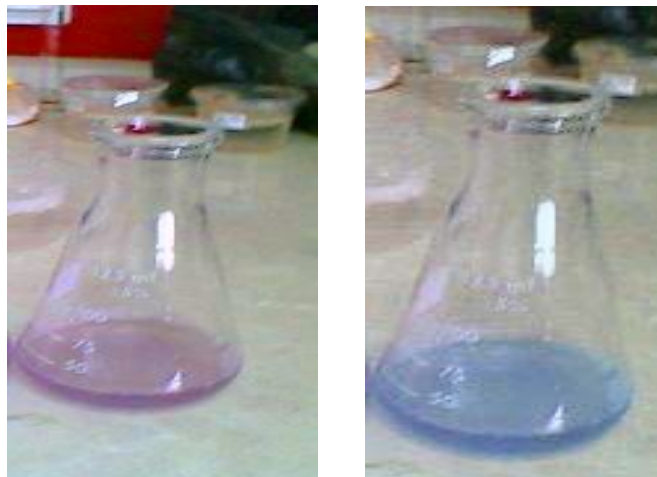
Gambar 3. Larutan Sampel Kulit Telur Sebelum dan Sesudah Titrasi Kompleksometri
