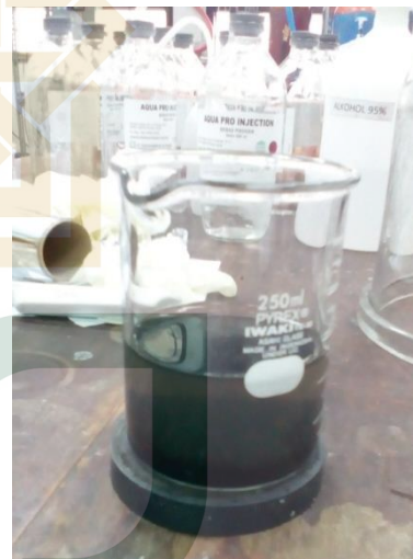
Proses pencucian sampel dengan diendapkan menggunakan magnet permanen
