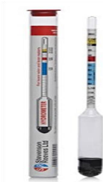
Hidrometer adalah alat yang digunakan untuk mengukur massa jenis zat cair. Proses pengukuran massa jenis zat cair menggunakan hidrometer dilakukan dengan cara memasukkan hidrometer ke dalam zat cair tersebut. Angka yang ditunjukkan oleh hidrometer telah dikalibrasi sehingga akan menunjukkan nilai massa jenis zat cair yang diukur.
