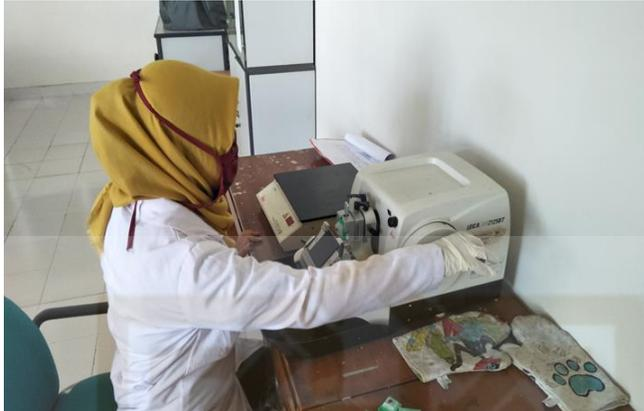
Lampiran 3. Proses pemotongan organ menggunakan mikrotom (*sectioning*)
