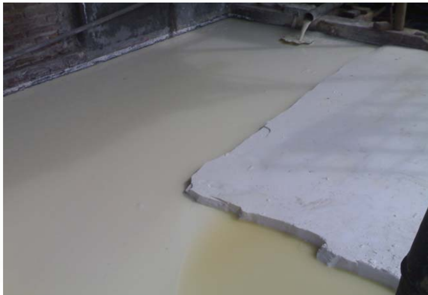
Gambar 4 : Proses Pengendapan Saripati Ketela
