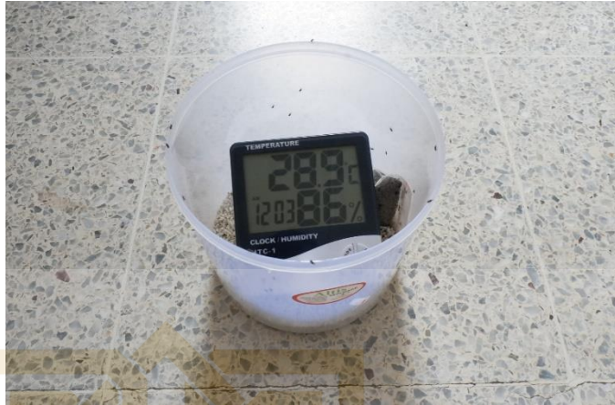
Gambar 16. Pengukuran suhu dan kelembapan udara dalam toples menggunakan termohigrometer.
